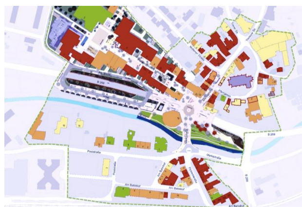
Auszug aus dem Energetischen Quartierskonzept (Quelle DSK, 2018), dunkelrot sind die Gebäude mit hohem Sanierungsbedarf, orange die Gebäude mit mittlerem Sanierungsbedarf und gelb diejenigen mit geringem Sanierungsbedarf markiert. In grünen Gebäuden besteht kein Sanierungsbedarf.
