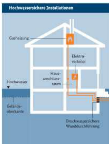
Abb. 15: Hochgelegte Technische Gebäudeausrüstung (BMWSB 2022)
